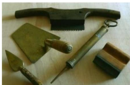
Petite et grande truelle, racloir à deux manches, pompe à humidifier et grattoir, internet
